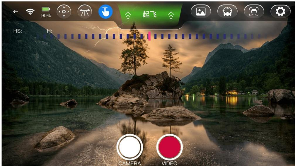
上升/下降、向左/右飞行：手指上/下、左/右滑屏；滑屏后不松手将持续进行相应动作。
