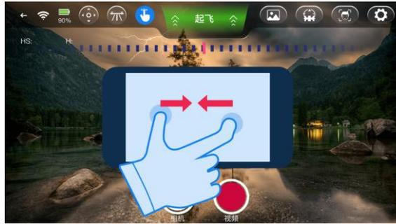
向后：双指向相反方向拨开滑屏；滑屏后不松手将持续进行相应动作
